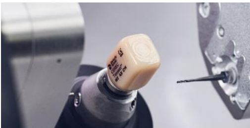
Abb. 3: CEREC Tessera ist eine weiterentwickelte Lithium-Disilikat-Keramik für den CEREC-Workflow, die sich in der CEREC Primemill hervorragend bearbeiten lässt.
